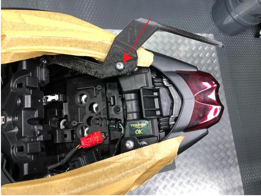
2\_ Rimuovere la vite del fianchetto, di seguito posizionare la maniglia.
