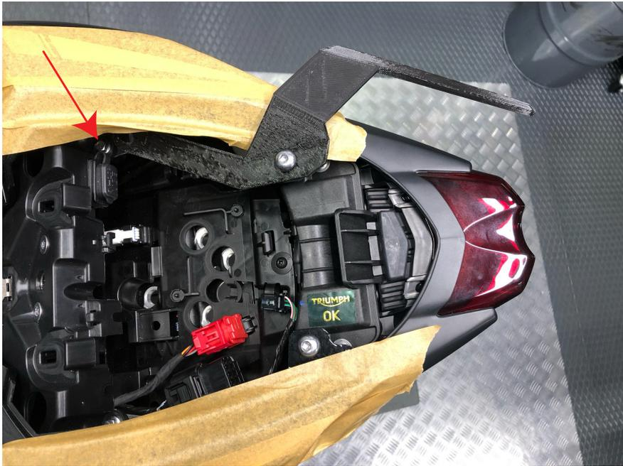
3\_ inserire la vite data in dotazione (M6 x 20 mm testa esagonale flangiata) nella sede indicata e la vite originale nella sede da cui è stata rimossa, e procedere con il montaggio della maniglia come indicato in foto.
